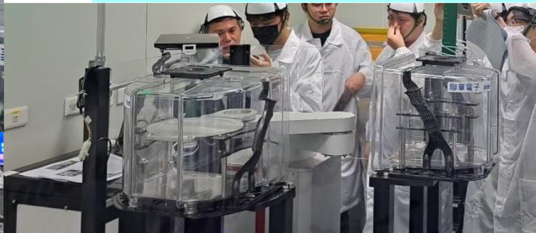
PLC儀控X-Z- \theta 晶圓傳輸手臂儀控模組
