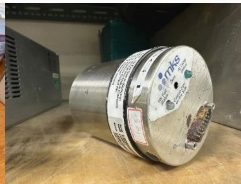
加熱型電容式真空計
